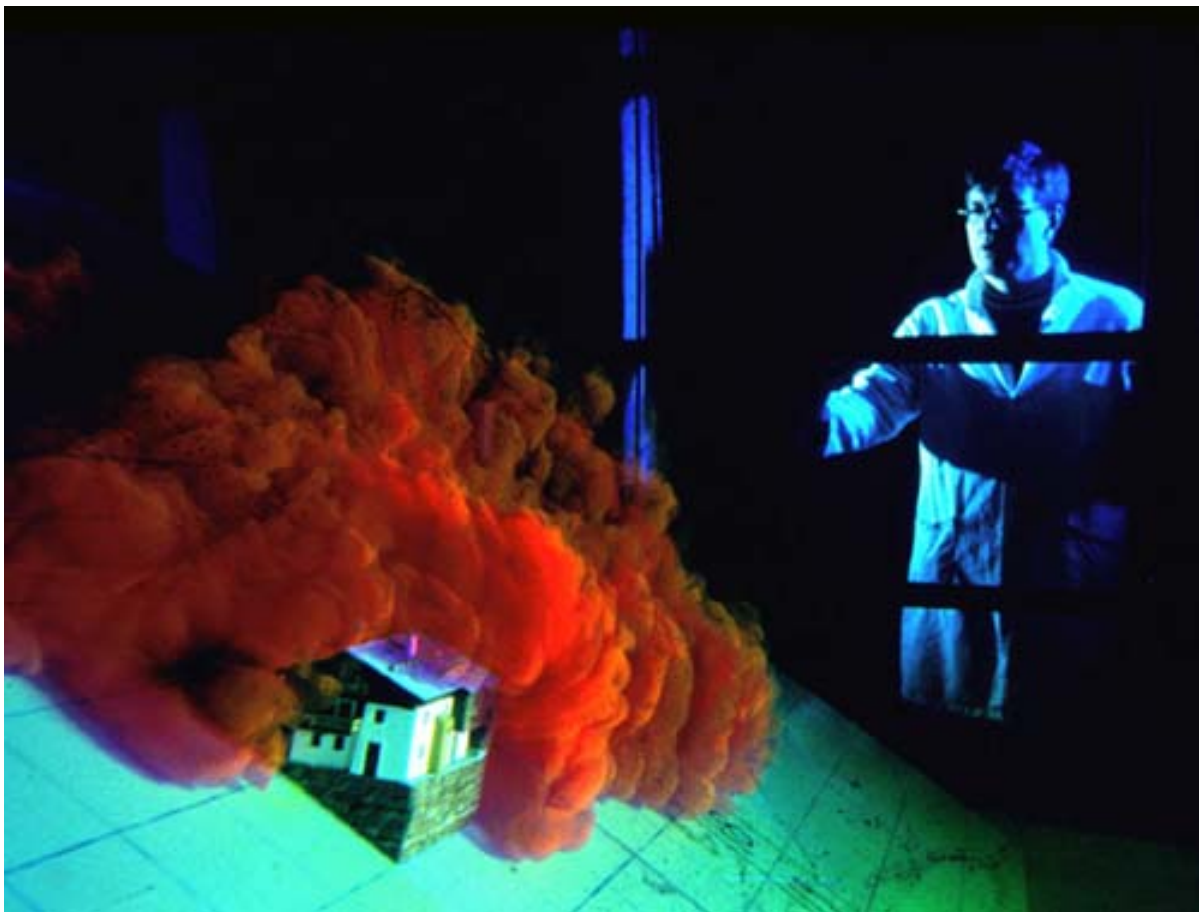
Essai en laboratoire (Cemagref) visant à reproduire une avalanche en aérosol.
